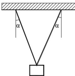
5. Лифт движется с ускорением, направленным вверх. К его потолку прикреплены две нити, на которых подвешен груз массой  $m = 10$  кг так, что нити составляют с вертикалью углы  $\alpha = 30^\circ$  (см. рисунок). При каком значении ускорения нити оборвутся, если они выдерживают натяжение  $T_0 = 60$  Н?
