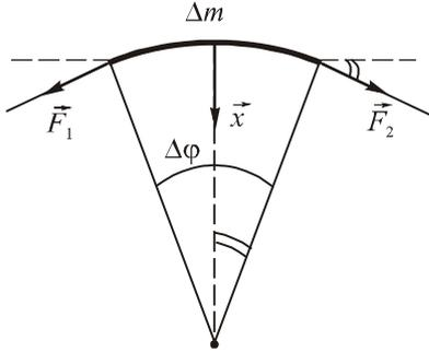
Рассмотрим движение элемента кольца, соответствующего малому центральному углу  $\Delta\varphi$ . Для него
