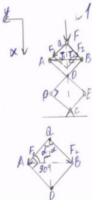
известно, что система неподвижна, следовательно, все действующие силы скомпенсированы. Запишем векторную сумму сил:
