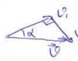
Отсюда:  $\cos \alpha = \frac{V_1}{V}$ ;  $V_1 = V \cdot \cos \alpha = \frac{3}{5}V$  — скорость 2R
